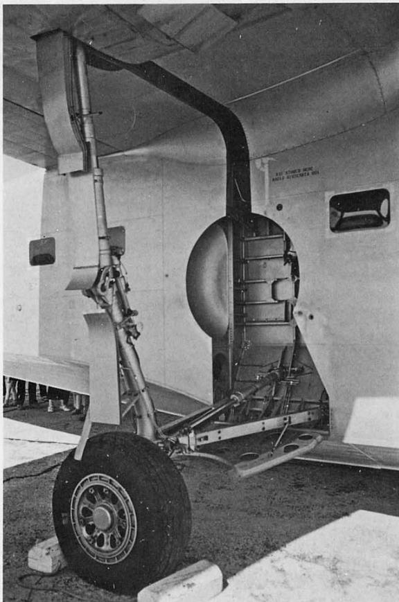
Foto 5 - Vista anteriore del carrello che ne permette di apprezzare la complessa architettura. Notare il simbolo dell'ascia ed i segni agli spigoli del finestrino che indicano dove si può forzare un'apertura di emergenza. Entrambi sono in arancione. (Foto E. Nocera)
