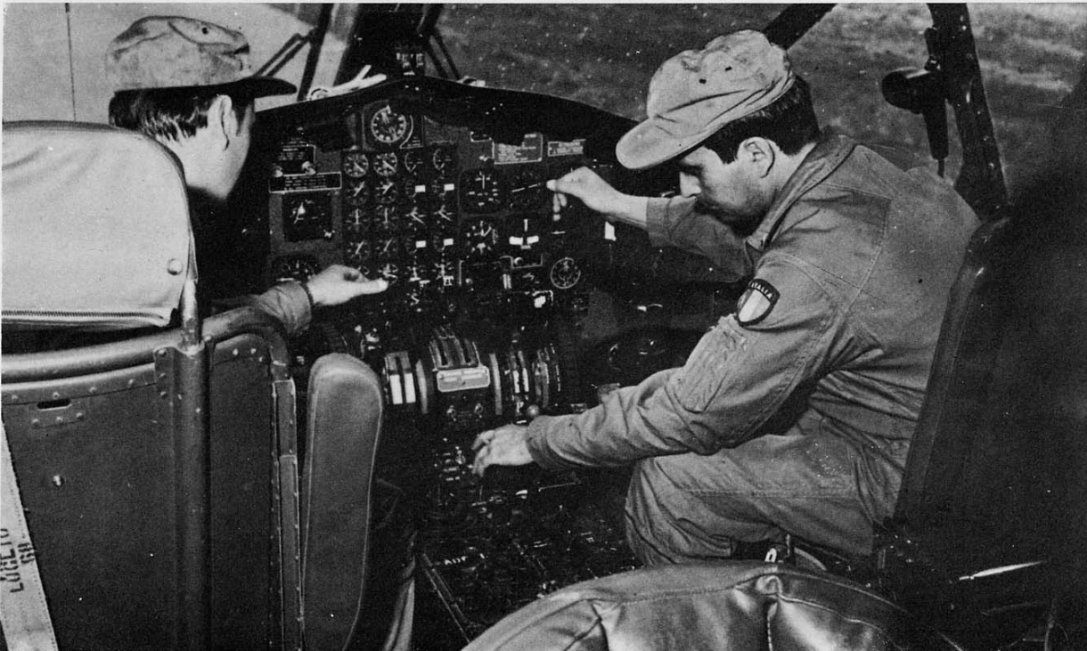
Ponte di volo di un C-119 con sullo sfondo una parte della complessa strumentazione; il colore di base dei pannelli che portano gli strumenti ed i comandi è grigio scuro. In primo piano si intravede la spalliera della poltroncina del navigatore. (Foto A.M.I)
