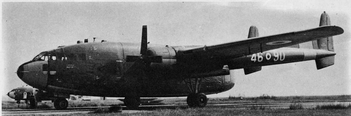
Un Vagone Volante del 98° Gr., 46 a A.B.T.M. fotografato nel settembre del 1971. Notare come si presenti corrugato il rivestimento metallico della fusoliera specialmente verso la coda. (Foto A.M.I)
