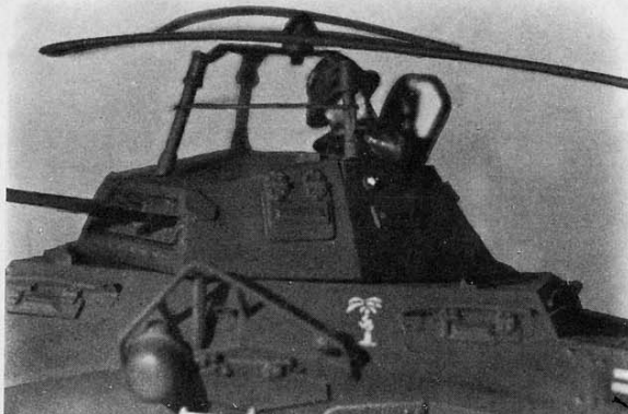
Modifica all'antenna semicircolare montata sui bracci di sostegno dell'antenna principale. Si noti il raccordo tra la predetta antenna e l'isolatore sulla torretta.
