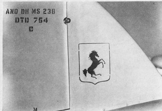
Particolare della deriva di un Vampire che mostra l'insegna del Cavallino Rampante del 4° Stormo in nero su fondo alluminio. Circa le scritte a sinistra, la prima riga potrebbe indicare un numero di costruzione progressivo, mentre la seconda dovrebbe riferirsi alla vernice impiegata per la finitura esterna. (Foto AMI)
