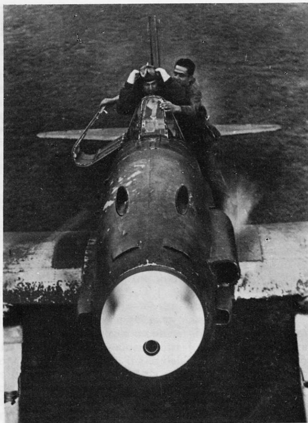
Questa insolita angolazione permette di rilevare diversi particolari utili a completare quanto indicato nell'articolo. Innanzi tutto la disposizione e la forma delle varie prese d'aria; poi la presenza delle "walk-way" che contrastano in modo netto con le superfici delle ali la cui vernice si è talmente consumata da lasciare ampie zone allo stato di "bare metal". (Foto A.M.I.)
