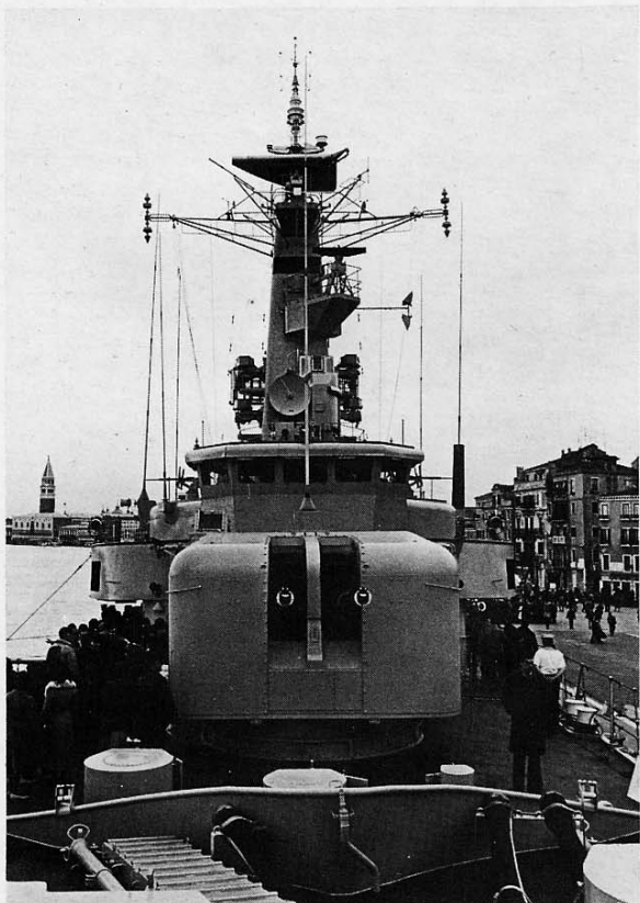
VISTA DI PRUA (NOTA LA TORRETTA BINATA E IL RADAR TYPE 993). (FOTO F. GASPARONI)
