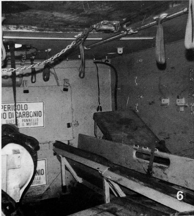
7 Vista generale del posto di pilotaggio; sulla sinistra vediamo l'estintore fisso e sopra di esso il sistema di illuminazione interno del carro; per chi non lo sapesse anche se qui si vedono male diciamo che la luce più grossa è bianca e viene adoperata durante le esercitazioni, la luce più piccola invece è di colore rosso e viene adoperata solo in tempo di guerra.
