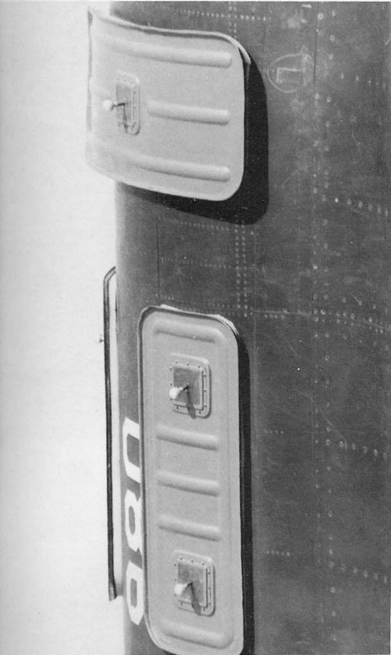
È bianco-metallico che si scurisce progressivamente procedendo verso l'esterno. In alto ed in basso a destra: le gondole in configurazione "tutto chiuso"; oltre alla classica chiusura delle prese d'aria principali con l'apposito "anello" di colore rosso, dotato di quattro maniglie appun- tate al centro (verniciate anch'esse in rosso, ma così consunte che lasciano scorgere il colore argento sot- tostante), sono presenti anche i pannelli che chiudono le prese d'aria supplementari. Questi pannelli, di due differenti tipi, (con una o due viti di chiusura) sono rappresentati nella fotografia, per la loro co- lorazione fare riferimento al testo.
