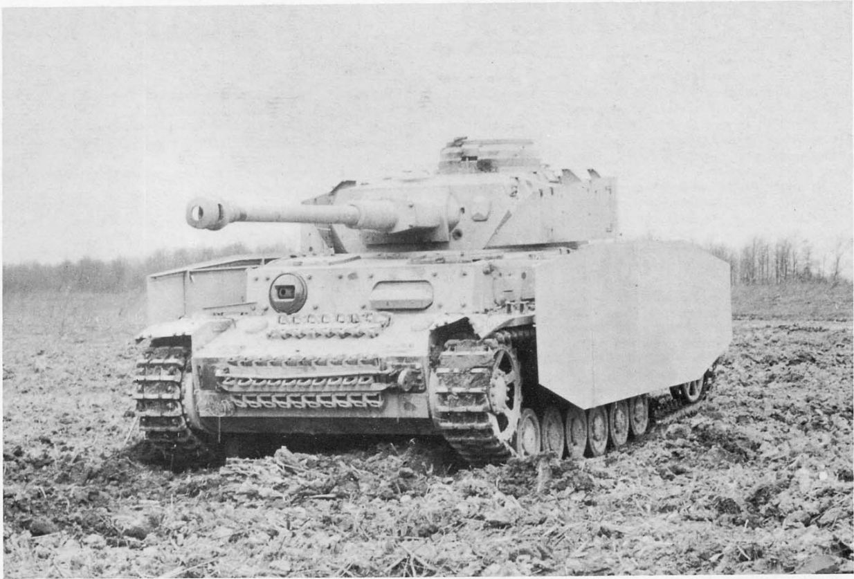
QUI SOPRA: Un Panzer IV H catturato dagli inglesi e trasportato in Inghilterra per prove di valutazione. Si possono notare la blindatura aggiuntiva nella parte anteriore dello scafo in corrispondenza della feritoia del pilota e dello snodo della mitragliatrice. Notare anche l'insegna della 16 a Panzerdivision presente sull'angolo superiore destro di tale piastra. QUI SOTTO: Un Panzer IV appartenente al 190 o Panzerbattalion della 90 a Panzergrenadierdivision ("Sardinia" notare l'insegna sulla piastra poste-
