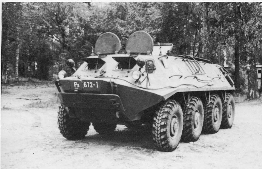
Un BTR-60PA dell'Esercito Finlandese. Il mezzo appare, come si direbbe per un aereo, con tutta la biancheria fuori! Si tratta della versione successiva al BTR-60P, che era aperto superiormente e quindi offriva ben poco riparo a qualsiasi tipo di offesa, tanto classica quanto NBC. Chiaramente visibili la targa e l'insegna di nazionalità finlandese, mentre poco chiari risultano essere alcuni contrassegni divisionali. (Esa Muikku, I.P.M.S.-Finlandia)
