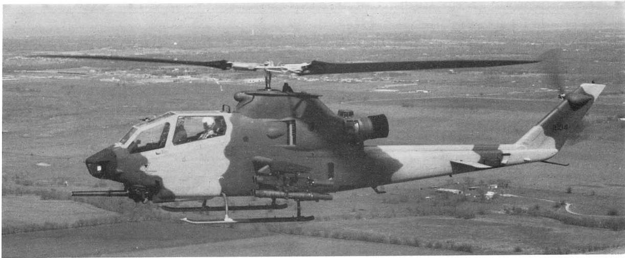
Sopra: Uno dei 24 AH-1S Modernized Cobra acquistati dalla Royal Jordanian Air Force, ripreso negli USA prima della consegna. I Cobra giordani hanno un interessante schema mimetico, a larghe bande in giallo sabbia FS-30400, marrone FS-30140 e verde FS-34097, con le estremità del muso e delle ali in verde FS-34052. (Foto Belle Helicopter Textron via Aldo Zanfi)
