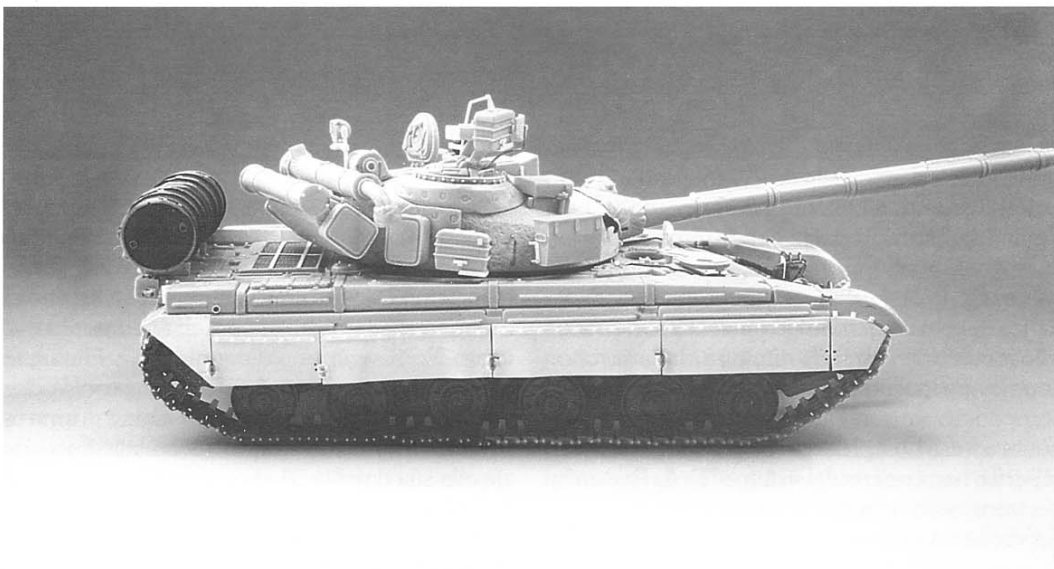
Qui a lato: Lato sinistro del T 64B realizzato dall'autore; le par- tie laterali in resina sono state ricostrui- te in plasticard per rispettare gli spessori e per ottenere un effetto di maggior realismo. (foto R.Vacirca)
