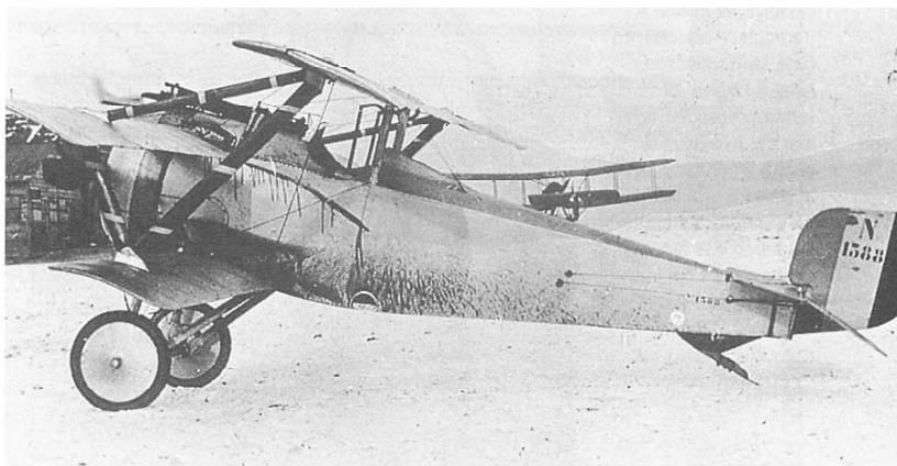
In basso: Lo stesso velivolo prima dell'applicazione del serial britannico sul timone; si notino le sporcature causate dal notevole consumo di olio che, spesso, caratterizzava il funzionamento dei motori rotativi. (foto WW 1 Aero)
