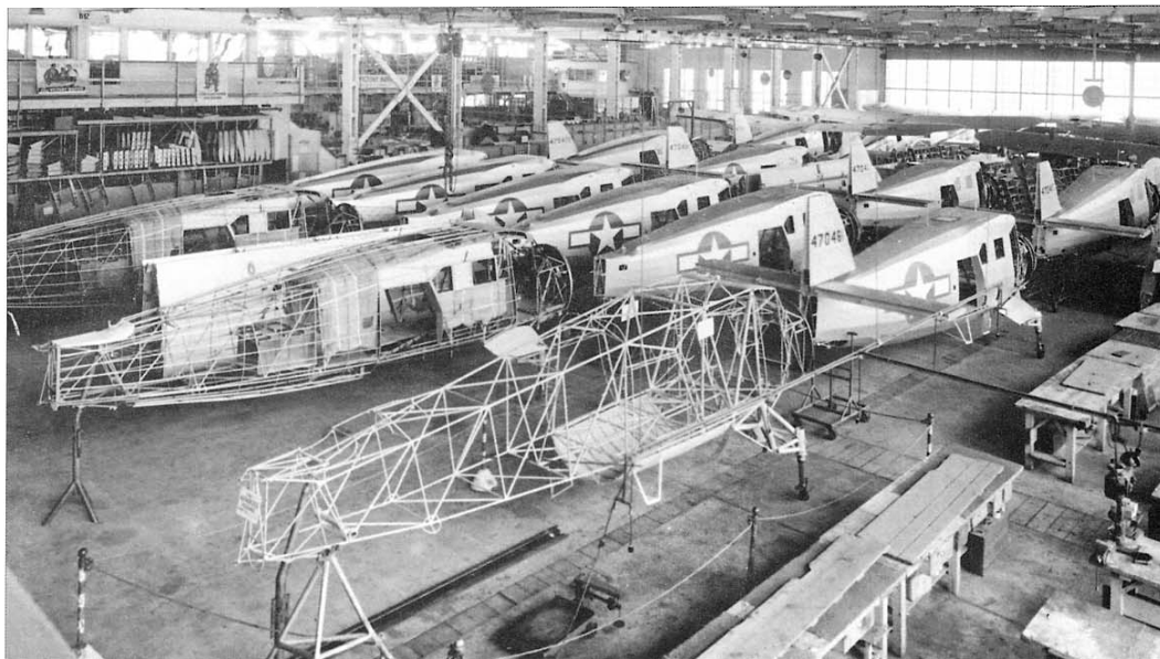
Qui a lato: Linea di montaggio del Norseman. Si nota in primo piano una struttura di fusoliera, costituita da elementi tubolari di acciaio saldati. L'aereo era costruito prevalentemente in legno; l'insieme era molto robusto e nello stesso tempo consente facili e rapide riparazioni. (foto US Air Force Museum, via F.Gasparoni)
