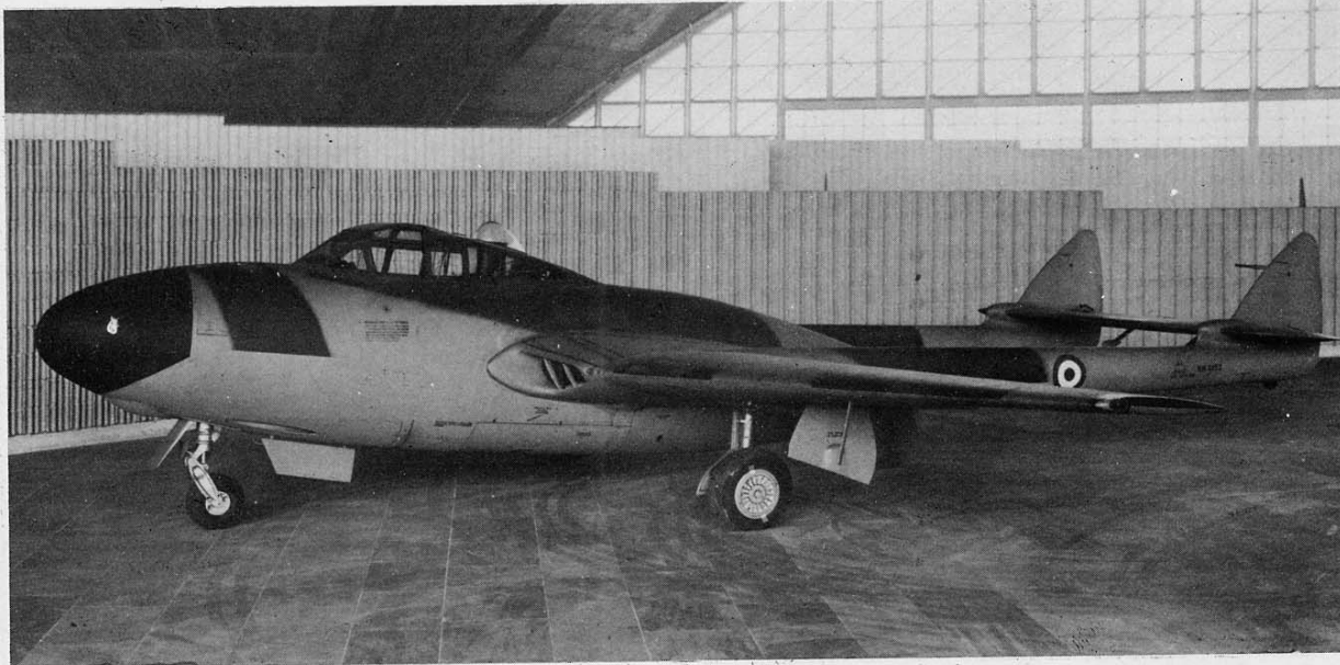
Il Vampire N.F. Mk. 10 precedentemente conservato al Palazzo della Vela a Torino e che ora dopo lo "sfratto" si trova a Vigna di Valle. La foto permette di apprezzare molti particolari del carrello e delle antenne. Ben visibile è pure la differenza di mimetizzazione tra questo velivolo e quello del disegno. (Foto A.M.I.)
