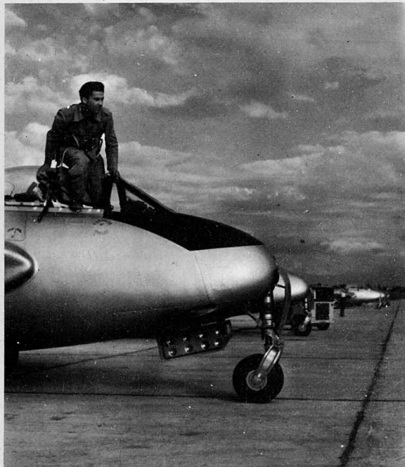
In questa foto si possono osservare i particolari del carrello anteriore e l'esatto andamento del pannello antiriflesso. Pure confermato dalla foto è l'uso del colore alluminio per gli interni del carrello. (Foto A.M.I. via N. Malizia)
