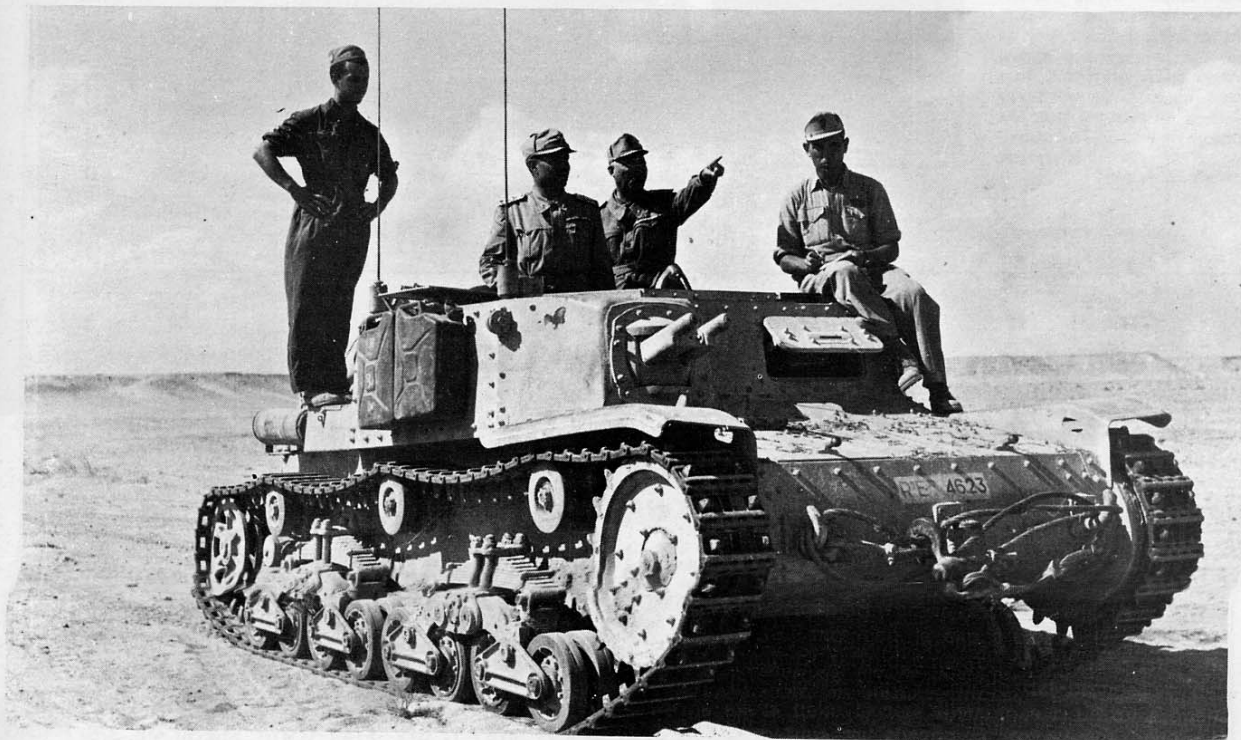
Sempre un carro comando su scafo M. 13/40 fotografato in Africa Settentrionale nel corso dell'avanzata della primavera del '42. Sul mezzo, targato 4623, si possono rilevare quei dettagli che rendono viva una riproduzione: tuniche ai lati, cavo di rimorchio, assenza del faro sul fianco destro, ecc. Anche per il carro comando si ripete il discorso già fatto per quello centro radio: l'articolo e i disegni si riferiscono alla versione M. 14/41, mentre le foto illustrano prevalentemente la M. 13/40. Si deve sempre lavorare più o meno sullo scafo base per correggere gli errori del kit e poi passare agli elementi di "specializzazione" per ottenere il carro comando. Si noti che il supporto a V rovescio situato davanti all'ufficiale con il braccio teso e destinato a portare l'armamento contraereo è tipico della versione M. 13/40, perchè nella successiva l'arma veniva fissata in modo diverso in un punto qualunque del bordo della casamatta. (Foto B. Benvenuti)
