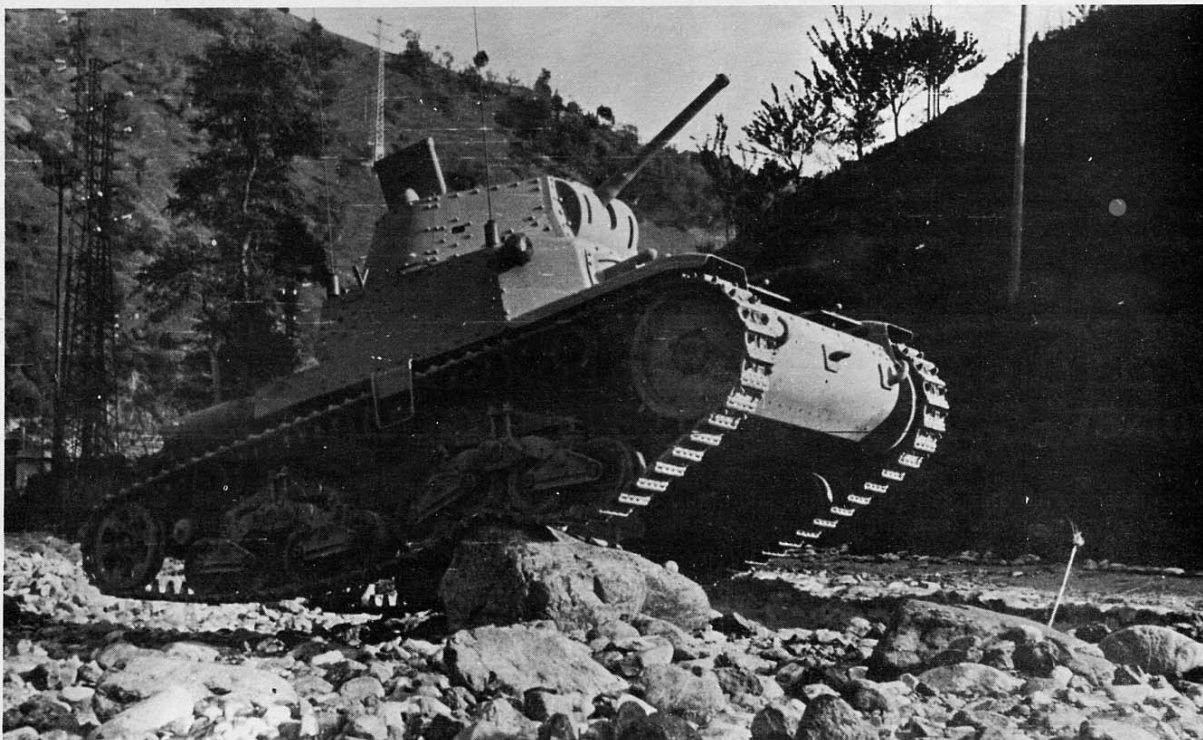
Un carro M. 13/40 nella versione centro radio. L'articolo fa riferimento solo al tipo M. 14/41 per via delle difficoltà (a suo tempo esaminate nel n. 5/3) che bisogna superare per ottenere un carro della versione 13 dal modello Italaerei. I primi mezzi centro radio furono ricavati da carri 13/40 della III serie. La foto ne mostra uno in fase di collaudo di accettazione nei dintorni di Genova.
