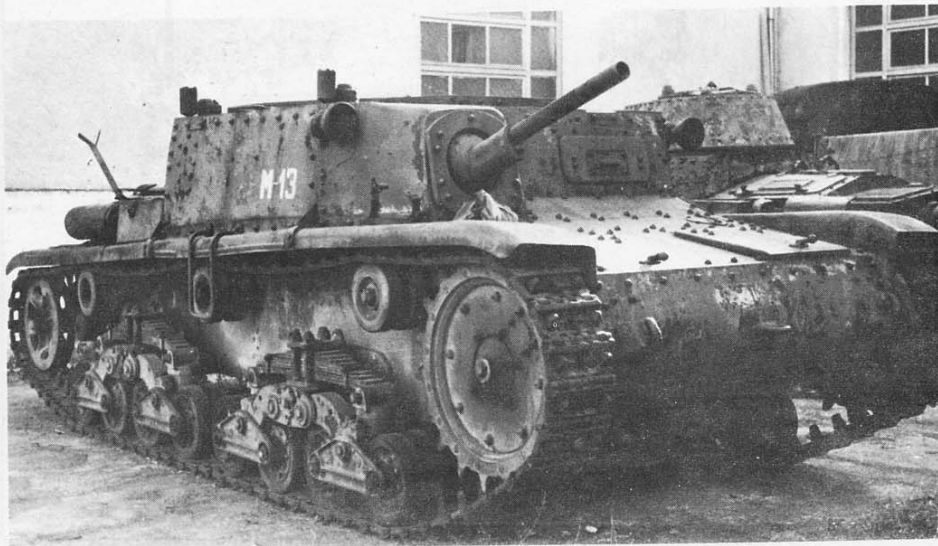
Ecco il malridotto esemplare del carro comando conservato presso il Museo della Motorizzazione della Cecchignola. La scritta M. 13 è errata perchè si tratta di un mezzo basato su scafo M. 14/41 come si può rilevare dai parafanghi lunghi e dalla mitragliera singola da 13,2 mm. Anche errata è la posizione del martinetto (che si intravede sotto gli stracci) davanti alla mitragliera. (Foto B. Benvenuti)
