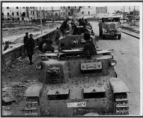
In primo piano un carro comando su scafo M. 13/40, come si rileva dall'armamento gemellato Breda da 8 mm. Normalmente ogni batteria di quattro semoventi aveva in dotazione un carro comando. La foto permette di bene apprezzare la disposizione dei quattro portelli di accesso che rimane inalterata anche per la versione su scafo M. 14/41. Le due antenne radio sul lato destro della casamatta sono ribaltate all'indietro e poggiano sui rispettivi supporti a "V". L'autocarro a destra della colonna è un 3R. (Foto B. Benvenuti)
