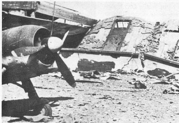
Questo particolare ci permette di vedere chiaramente l'ogiva coprimozzo, la presa d'aria di tipo tropicale ed una ruota; la mimetica a macchie si estende alle superfici inferiori.
