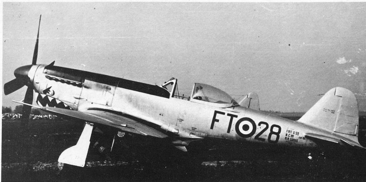
Vista laterale dello stesso velivolo del quale altrove è mostrato il dettaglio del muso. Il codice FT dovrebbe indicare la denominazione NATO Fighter Training. Notare la variante del pannello antiriflesso che scende fino agli scarichi motore e i caratteri giapponesi davanti il timone di quota. La protuberanza dietro il ruotino di coda potrebbe essere un dispositivo per il rimorchio di bersagli. (Foto P. Borgonovi)
