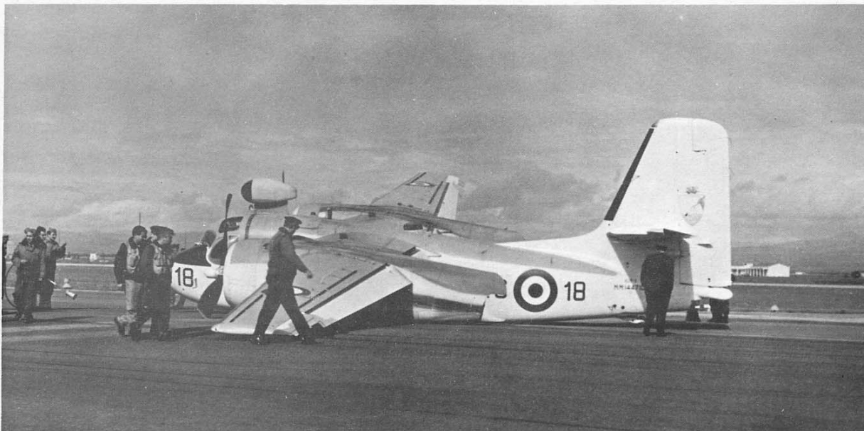
Da questa istantanea colta alcuni minuti dopo l'atterraggio poco ortodosso (si può leggere lo stupore e la curiosità dei presenti) si rilevano alcuni particolari interessanti quali l'assenza delle "walkway" sulle ali, l'asta dell'antenna piccola e la sistemazione dei filari, il secondo specchietto su cofanatura motore visibile vicino all'asta dell'antenna e la colorazione più chiara del radome ECM. (Foto G. Garellò)
