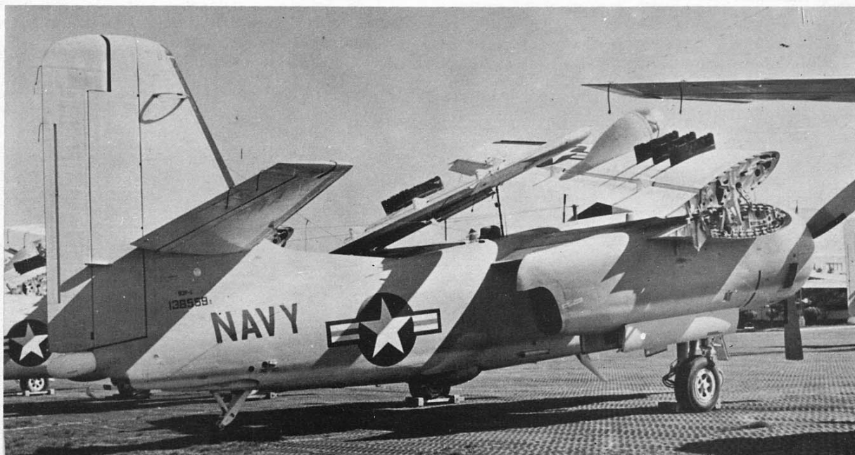
Vista 3/4 posteriore di uno dei velivoli (136559) al momento della consegna dove si vede chiaramente sulla deriva verticale l'antenna semicircolare del VOR e l'assenza sotto al MAD dell'antenna del TACAM e, sopra e sotto la fusoliera, del beacon anticollisione; inoltre sono ben visibili tutti i filari d'antenna e quella a stilo. Infine notare l'andamento della zona verniciata in bianco ed i tre piloni subalari verniciati, sembrerebbe, in nero.
