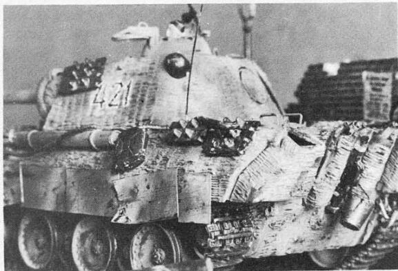
Particolare di 3/4 posteriore del modello che mette in risalto gli scarichi, l'andamento dello Zimmerit e la disposizione degli scudi "schürzen".
