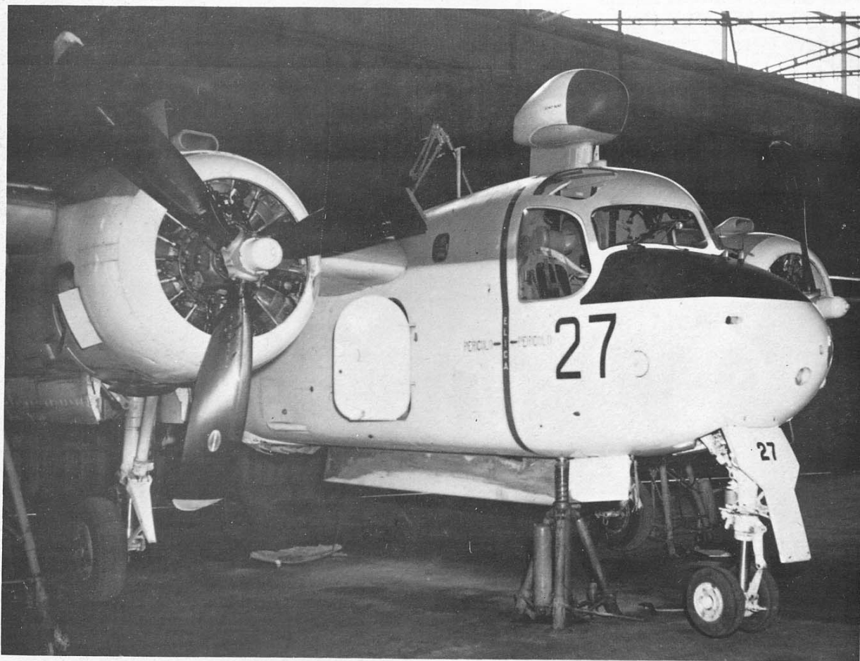
Primo piano di un velivolo danneggiato per atterraggio senza carrello (1963) che permette di cogliere molti dettagli tra cui alcuni relativi all'abitacolo. Si nota la cupola del radar spaccatasi nella strisciata e i fori sulla fusoliera prodotti dai frammenti dell'elica. (Foto G. Garellò)
