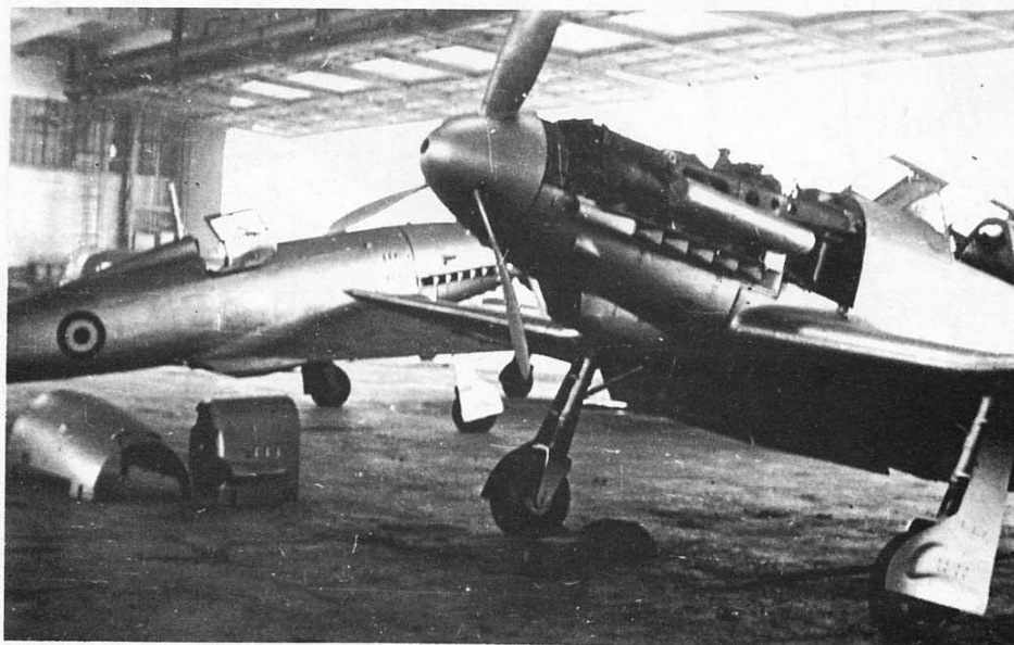
Manutenzione su due FIAT G.55 della scuola di Lecce, rispettivamente un A (che differisce dalla versione bellica solo per la mancanza dell'armamento) sul retro e un B biposto in primo piano. Notare la mancanza del compasso sul carrello che comparirà nei G.59. (Foto A.M.I.)
