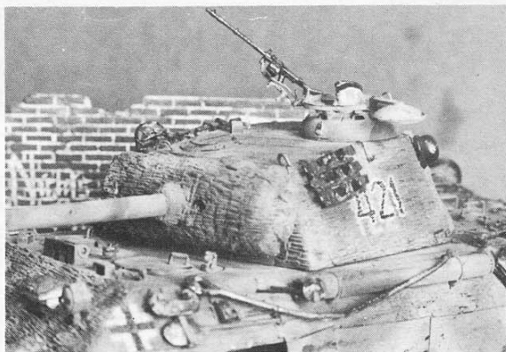
In questa immagine del modello realizzato dall'autore si possono apprezzare alcuni particolari come le maniglie sul cielo della torretta e il supporto per la MG. 34.
