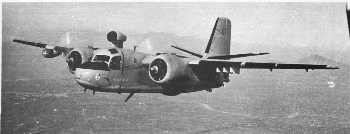
Uno dei primi velivoli in forza all'86° Gruppo nel 1957-58 e del quale porta il distintivo su muso e deriva verticale. Si nota chiaramente l'assenza del faro, dell'antenna TACAM sotto al radome ECM e tutte le altre piccole differenze messe in risalto nella didascalia della foto a pag. 2. Solo dopo il 1960 questi sei velivoli vengono equipaggiati sullo standard dei velivoli delle serie successive. (Foto A.M.I.)
