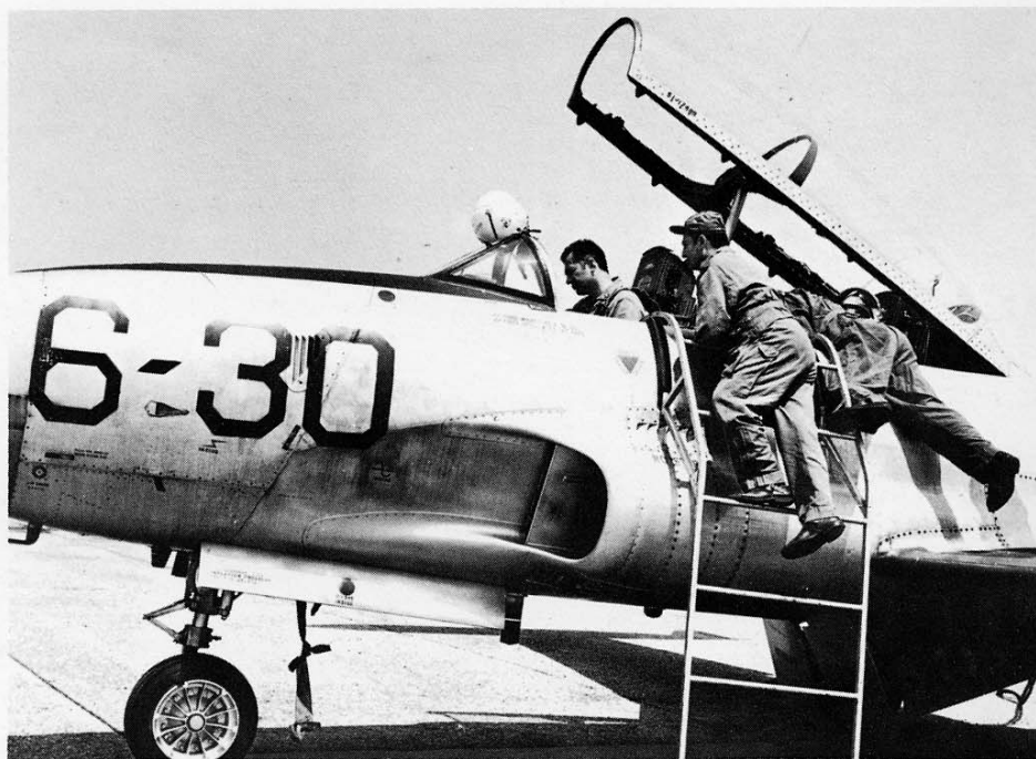
Un altro T-33 della 3ª Aerobrigata, in questo caso la M.M. 51-9030; la matricola è riportata con caratteri molto piccoli anche sul cono anteriore delle taniche alari. Sotto il codice, peraltro di stile arrotondato, si possono distinguere le cifre 661 che non avendo nessuna relazione con la matricola potrebbero far pensare ad una sostituzione dell'intero muso. (Foto A.M.I.)
