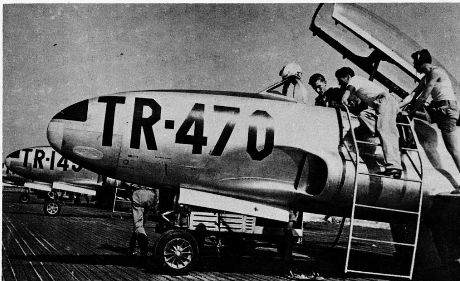
Vista di 3/4 frontale di un T-33 della Scuola di Amendola, data 4/5/1955, che mostra chiaramente il terzo tipo di cerchione con fori di alleggerimento circolari. Si può anche osservare la tenuta di volo del pilota che è del tutto conforme a quelle usate a quel tempo dall'USAF.
