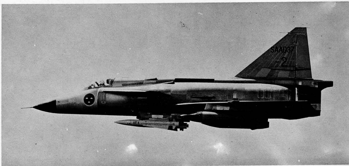
Il secondo prototipo del Viggen nella versione AJ37 da attacco ogni-tempo equipaggiato con il missile aria-superficie SAAB RB05A; dietro, sotto le ali, si notano due pod lanciarazzi. L'importo iniziale del contratto di produzione del velivolo per l'Aeronautica Svedese ammontava a 180 milioni di corone. La foto risale al 1970. (Foto SAAB via Bignozzi)
