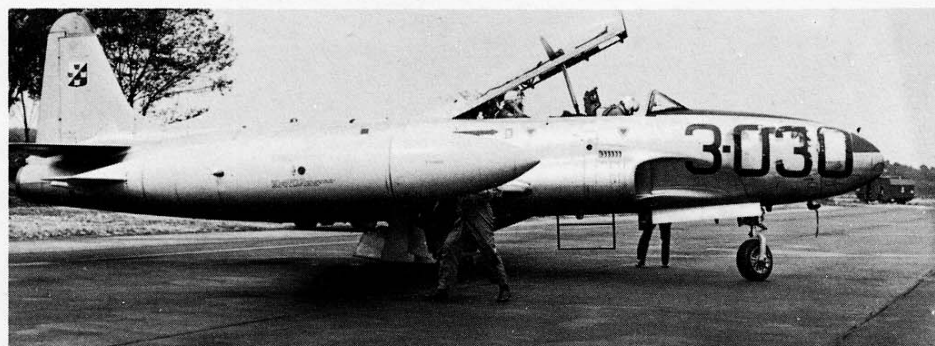
Un altro T-33 della 3ª Aerobrigata, in questo caso la M.M. 51-9030; la matricola è riportata con caratteri molto piccoli anche sul cono anteriore delle taniche alari. Sotto il codice, peraltro di stile arrotondato, si possono distinguere le cifre 661 che non avendo nessuna relazione con la matricola potrebbero far pensare ad una sostituzione dell'intero muso. (Foto A.M.I.)
