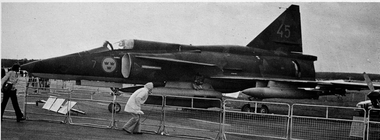
Il Viggen nella versione da ricognizione SF 37 presente all'edizione 76 di Farnborough. Essa è facilmente distinguibile per la particolare forma appuntita del muso che non ospitando più il radar ma le fotocamere è mimetizzato completamente. Il numero individuale sulla deriva è in arancione day-glo, mentre quello di reparto davanti alla presa d'aria è giallo. (Foto A.M. BELLEI)
