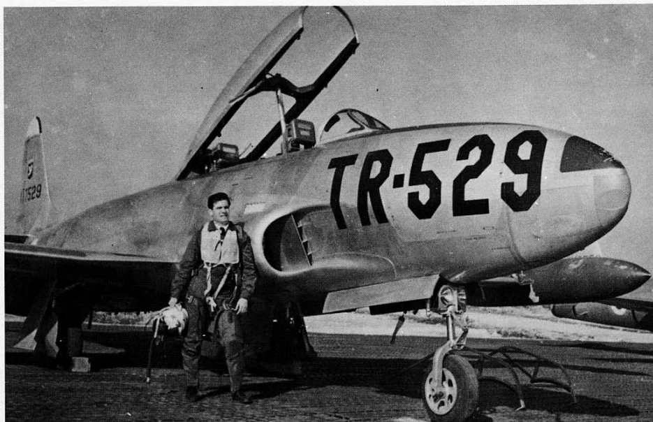
Vista di 3/4 frontale di un T-33 della Scuola di Amendola, data 4/5/1955, che mostra chiaramente il terzo tipo di cerchione con fori di alleggerimento circolari. Si può anche osservare la tenuta di volo del pilota che è del tutto conforme a quelle usate a quel tempo dall'USAF.
