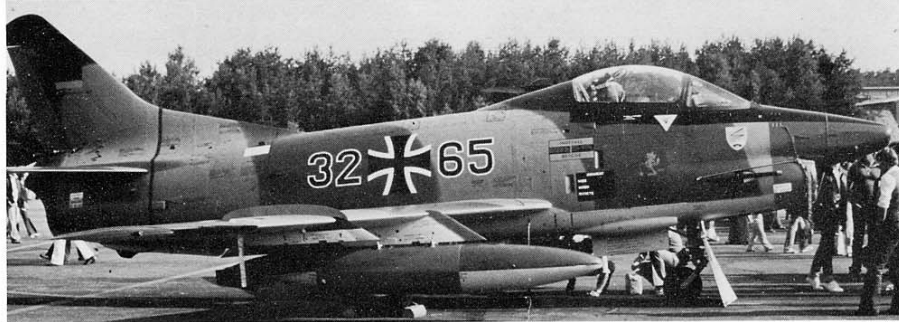
Vista di profilo di un G.91 R-3 del LeKG 43 della Luftwaffe: mimetizzazione standard con zone arancio day-glo. Ben visibile il tettuccio rialzato per permettere l'installazione del seggiolino eiettabile «0-0». Da notare il curioso lupacchiotto giallo che fa... la «pipì», proprio sotto l'abitacolo. (foto Guerri)
