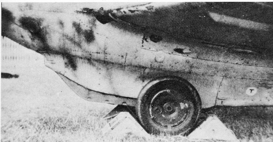
Interessante immagine del pattino e di una delle ruote del piccolo carrello che permetteva il rullaggio del «Komet».
