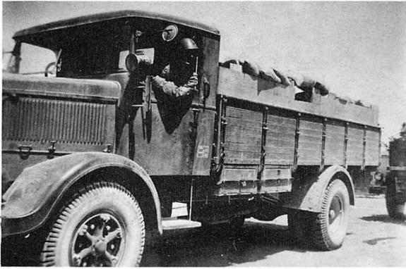
DUE FOTO CHE MOSTRANO UNA INTERESSANTE TRASFORMAZIONE IMPROVVISATA SUL CAMPO SU DI UN ESEMPLARE DI LANCIA 3/RO, PROBABILMENTE IN AFRICA. L'AUTOCARRO È STATO TRASFORMATO IN FORTINO MOBILE CON L'AGGIUNTA DI
