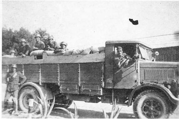
UN RIALZO DI ASSI DI LEGNO E SACCHI DI SABBIA A ULTERIORE PROTEZIONE DELLA TRUPPA. UN'IDEA PER UNA TRASFORMAZIONE MODELLISTICA. (ARCHIVIO F. MIGLIA)
