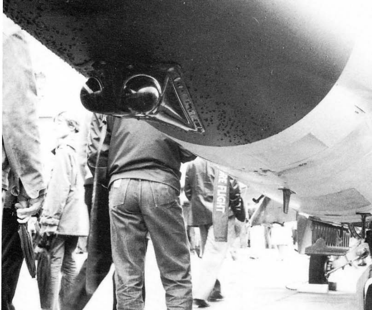
Dettaglio tipico dei CF-104 canadesi sono le "bugne" del sistema per la guerra elettronica, presenti nella parte inferiore del radome anteriore ed in coda, ai lati dello scarico (vedi anche foto a pag. 23), chiaramente visibili in queste immagini. (foto Alberto Zanfi e Aldo Zanfi - IPNS Modena)
