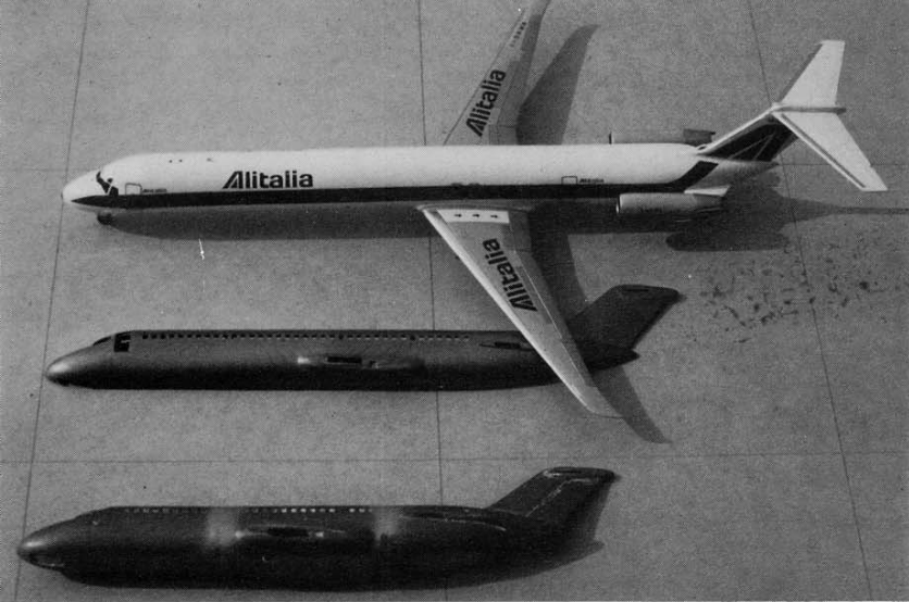
QUI A LATO - Un'altra immagine del modello del DC-9 Super 80. Questa volta si possono ben confrontare le diverse lunghezze del modello base e della riproduzione dell'ultima variante del bireattore statunitense. Come ricordato nell'articolo, con quanto rimane della fusoliera del secondo modello necessario per questa conversione, si può agevolmente riprodurre un DC-9 "corto", ossia un Serie 10, la cui fusoliera è visibile in basso. (Valerio D'Orio. IPMS - Roma)
