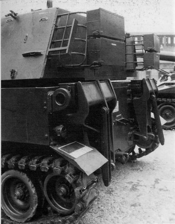
SOPRA A SINISTRA - Immagine posteriore del semovente con i vomeri in posizione di marcia. Si vede la leva di cui accennato in altra parte dell'articolo. Anche il supporto per il telefono da campo fornito nel kit è errato,
