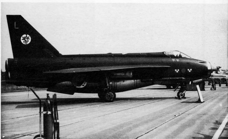
F.2A ripreso durante una manifestazione aerea in Germania, nella tipica "livrea tedesca" completamente in Dark Green con superfici inferiori in metallo naturale. La versione F.2A si può facilmente riconoscere dai cannoni montati sul muso, di cui uno è ben visibile. Il missile Firestreak è anch'esso in Dark Green. (foto via Giorgio Pini)
