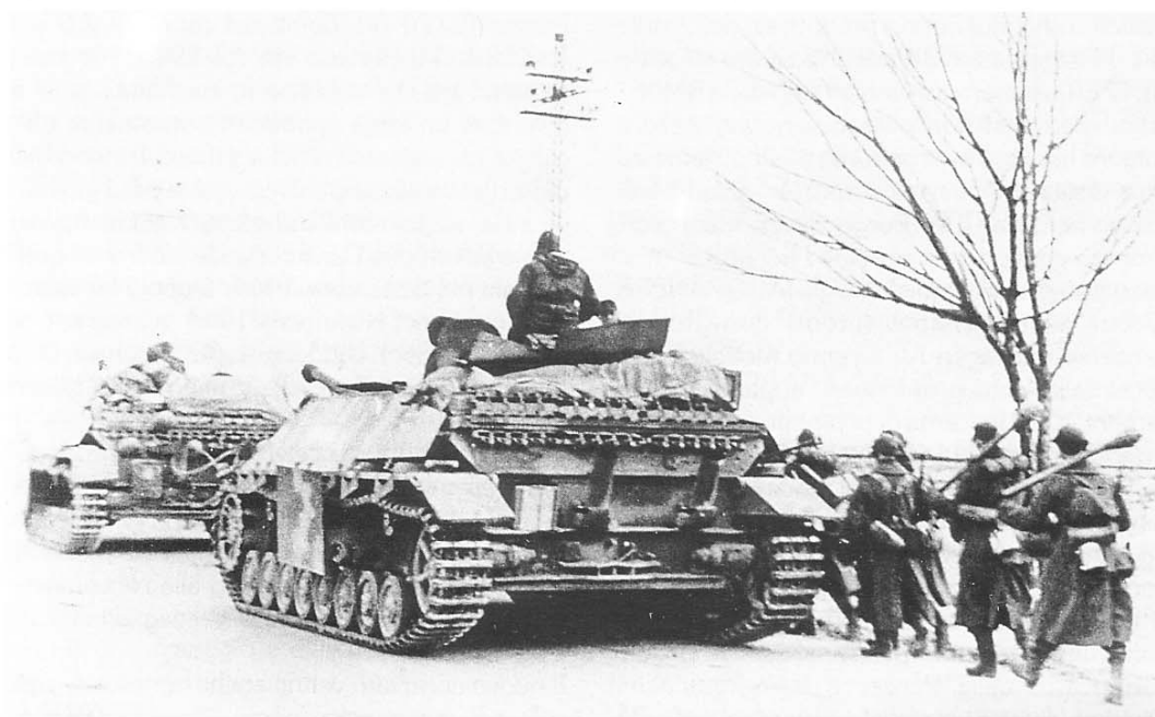
Pz.IV/70(V) prodotto nell'autunno del 1944, ancora dotato di otto rulli gommati per lato. (foto arch. C. Pecchi)
