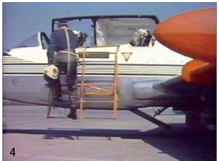
Foto 4/5 - In queste immagine si nota oltre alla scaletta per l'accesso agli abitacoli, la posizione del telo dell'abitacolo posteriore per simulare il volo strumentale nella sua posizione aperta ripreso da altra angolazione e visibile ancora nella Foto 5 nella pagina successiva.
